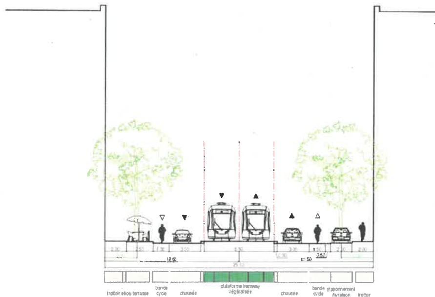
Coupe Maréchal Juin avec suppression des palmiers et aménagement urbain avec affectation voiture, cycle et piéton séparée
